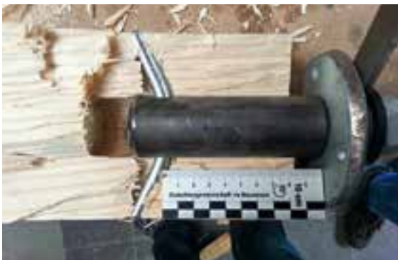
Abb. 2: Aufgetrennter Prüfkörper des Typs K1 nach einem Zugversuch.
