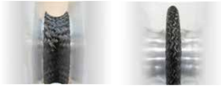
Abb. 4: Drapierversuche an Modellkerngeometrien mit Prepregsystemen.
