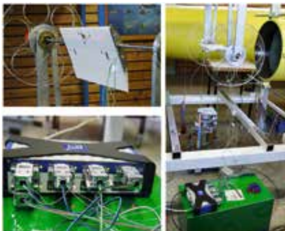
Abb. 10: Tragflügel mit DMS sowie strukturmekanischer Aufbau im Windkanal.
