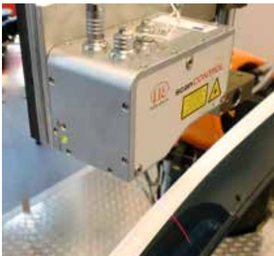
Abb. 2: Kamera basierte Objekterkennung und Laserscanner basierte Bahnführung eines Industrieroboters bei gleichzeitiger Präzisionsvermessung von Prüfmerkmalen an einem beliebig frei im Messraum platzierten Messobjekt, hier eine Autotür.
